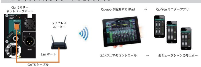
**ワイヤレスルーターのセットアップ** - Cat5 ケーブルを使用して、ルーターと PC または Mac を接続します。ルーターの製造元が提供する説明書に従って、そのセットアップメニューにアクセスします。 セットアップが完了したら、ルーターをコンピューターから取り外し、Cat5 ケーブルを使用して Qu ミキサーのネットワークポートに接続します。
